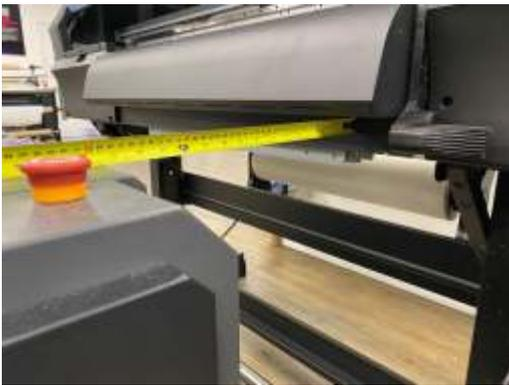
**5** Stellen Sie den Drucker, wenn möglich, mit einer Wasserwaage (mit verstellbaren Füßen) waagrecht auf. Richten Sie das Gerät anschließend waagrecht aus, indem Sie die Gummifüße über das rote Einstellrad absenken.
