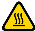
“Superficie calda” e viene utilizzato per avvertire le persone di fare attenzione a evitare il contatto con superfici calde.
