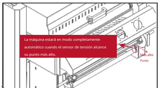
La máquina estará en modo completamente automático cuando el sensor de tensión alcance su punto más alto.
