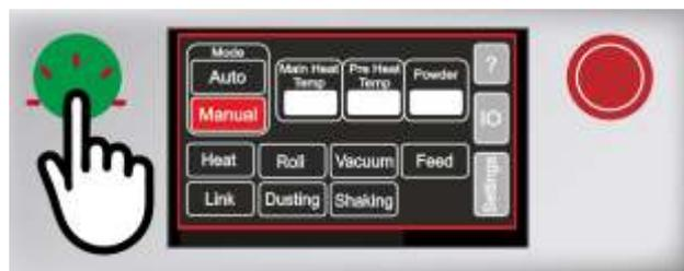
Apague la máquina mediante el interruptor de encendido, espere 5 segundos y vuelva a encenderla. El reinicio ya se ha completado.
