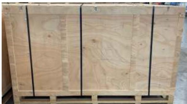
Coloque la caja en una posición plana y nivelada, y que tenga suficiente espacio para desembalar y retirar la máquina de la paleta.
