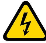
« Avertissement ; électricité » et il est utilisé pour avertir les gens du risque d'entrer en contact avec l'électricité (par exemple, choc électrique, risque d'électrocution, tension dangereuse).
