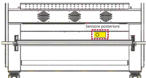
Una volta terminata la cottura, la pellicola di trasferimento uscirà dal forno. Il sensore posteriore viene utilizzato per rilevare se la pellicola di trasferimento ha completato la cottura ed è emersa dal retro.
