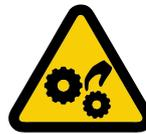
“Pericolo di schiacciamento” e viene utilizzato per avvisare le persone di fare attenzione a evitare il contatto con le parti in movimento durante il funzionamento.
