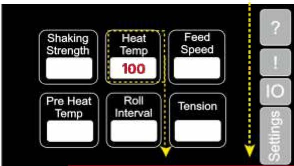
La temperatura visualizzata nel menu principale "Temperatura riscaldamento" deve corrispondere alla "Temperatura riscaldamento" impostata nel parametro.
