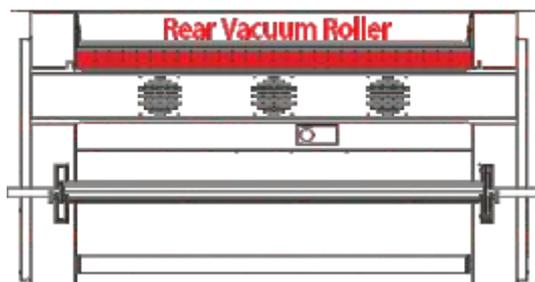
Una volta che la pellicola viene rilevata dal sensore posteriore, il rullo di aspirazione anteriore interromperà l'aspirazione ma continuerà a trasportare la pellicola, mentre il rullo di aspirazione posteriore manterrà entrambe le funzioni di aspirazione e trasporto.
