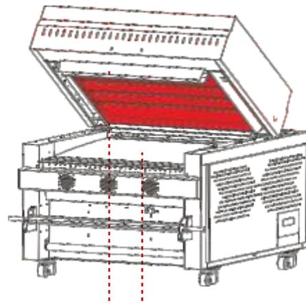
Le doppie file superiore e inferiore di lampade riscaldanti ad alta efficienza (la fila inferiore è sotto la cinghia di alimentazione)
