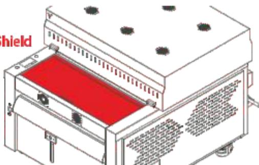
La funzione dello scudo antipolvere è quella di impedire che la polvere schizzi. Se viene aperto mentre la macchina è in funzione, la funzione di agitazione della polvere si interromperà. Una volta chiuso, la funzione di agitazione della polvere riprenderà.
