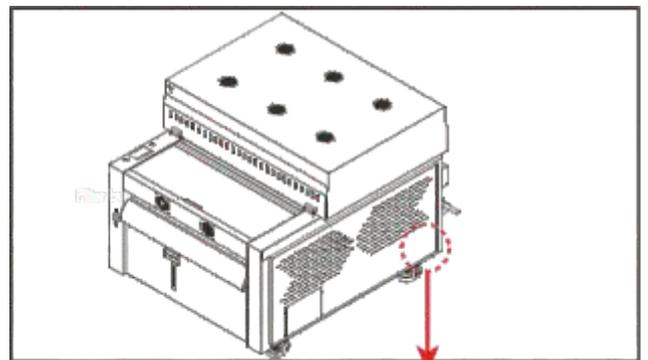
Dopo un uso continuo assicurarsi di aprire la valvola inferiore del filtro per drenare l'olio raccolto
