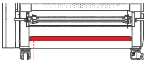
Capteur de tension Situé sous le rouleau récepteur.
