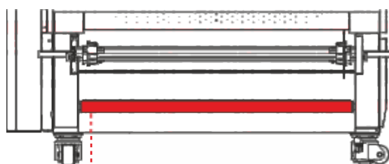
Sensore di tensione Situato sotto il rullo di avvolgimento.
