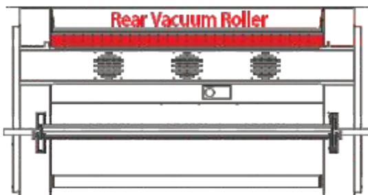
Sobald der Film vom hinteren Sensor erkannt wird, stoppt die vordere Vakuumrolle die Saugfunktion, transportiert den Film jedoch weiter, während die hintere Vakuumrolle sowohl die Saug- als auch die Transportfunktion aufrechterhält.
