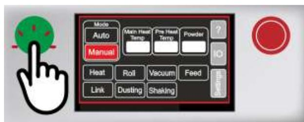
Schalten Sie die Maschine mit dem Netzschalter aus, warten Sie 5 Sekunden und schalten Sie die Maschine wieder ein. Der Reset ist nun abgeschlossen.
