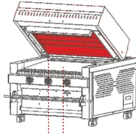
Die oberen und unteren Doppelreihen hocheffizienter Heizlampen (die untere Reihe befindet sich unter dem Zuführband)
