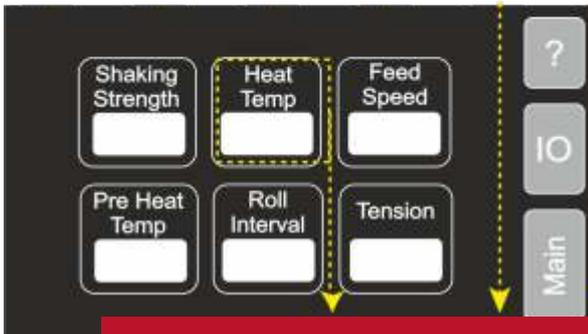
Die im Hauptmenü unter „Heiztemperatur“ angezeigte Temperatur muss mit der im Parametersatz eingestellten „Heiztemperatur“ übereinstimmen.
