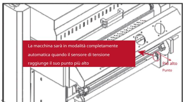
La macchina sarà in modalità completamente automatica quando il sensore di tensione raggiunge il suo punto più alto
